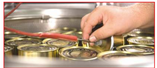
Per Stichsonde wird der Kochvorgang im Produkt gemessen.
