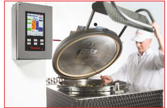
Das Bedienfeld der Kochprozesssteuerung wird separat montiert, liefert und speichert alle Informationen und bietet die Möglichkeit zum berührungslosen Datenaustausch.
