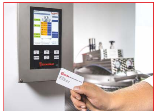
Mit einer Chipkarte erfolgt der Austausch der Daten.
